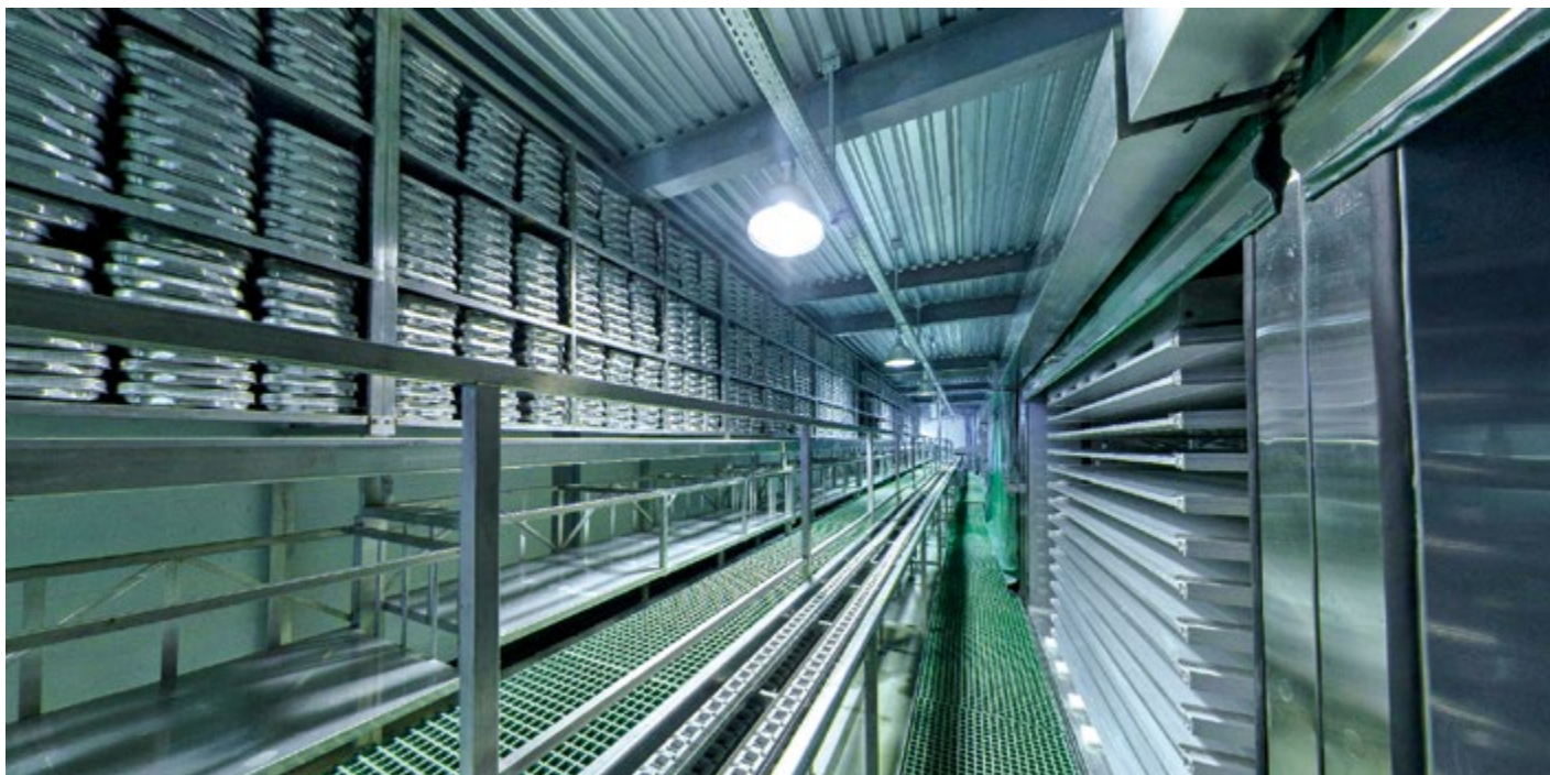
Современный морозильный комплекс обеспечивает заморозку рыбы до -28^{\circ}\text{C} всего за два часа
