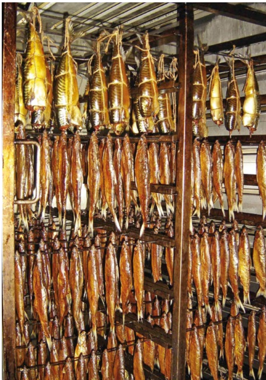
Копчение рыбы в вертикальном положении в термокамере Thermostar 2.0
