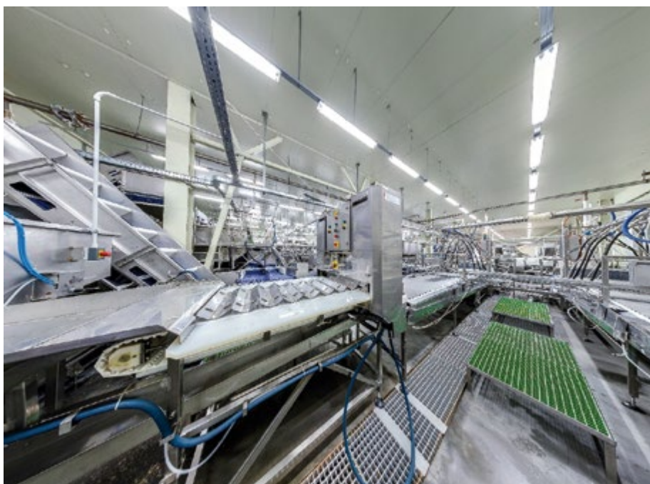
Линия переработки лососевых на основе пазового конвейера. ЛР-45/90ПК
