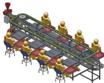
Визуализация линии нанизки рыбы для предприятия в России
