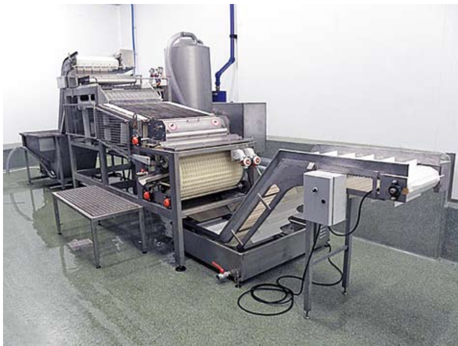
Линия обезглавливания и потрошения мелкой пелагической рыбы
