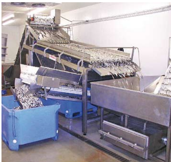
Роликовый сортировщик мелкой пелагической рыбы
