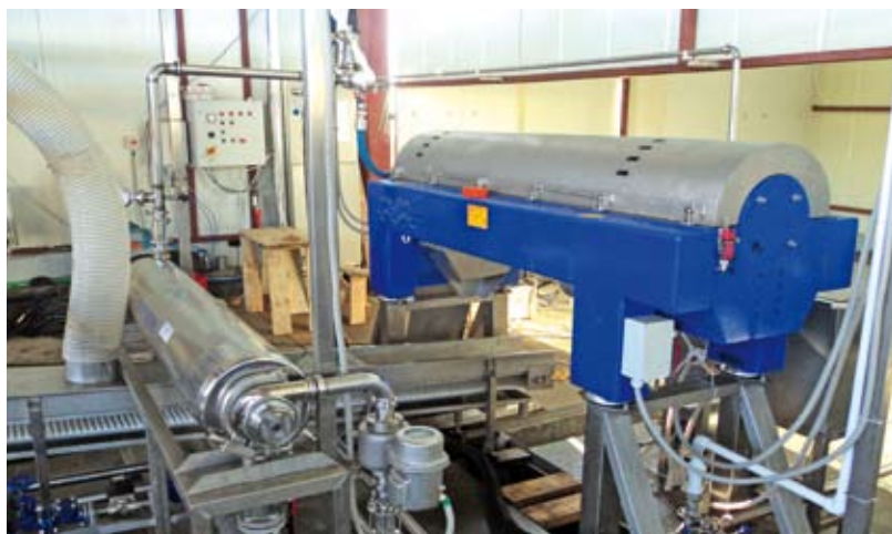
В основе линии ПРО – скребковый теплообменник Conterm и трехфазный декантер производства Alfa Laval
