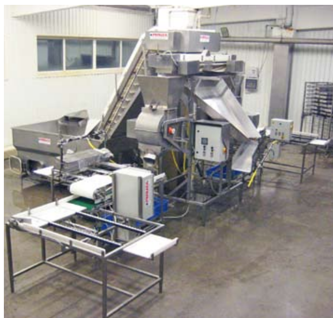
Линия объемного дозирования мелкой пелагической рыбы
