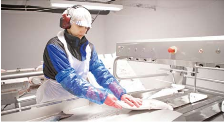
Подающее устройство для сортировки по качеству и весу
