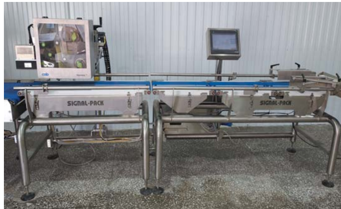
Линия взвешивания и маркировки упакованной рыбы
