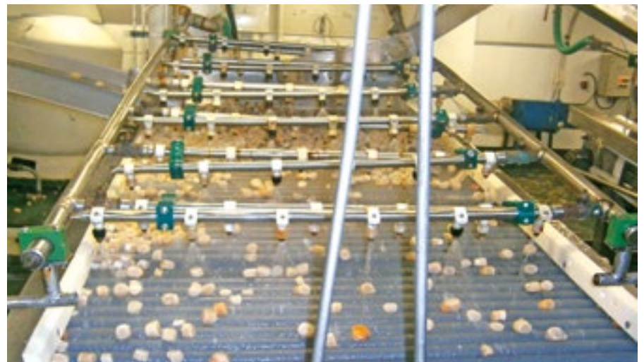
Судовая фабрика делится на два уровня: на верхнем, куда поступает сырье из приемного бункера, происходит черновая обработка. Затем гребешок дочищается до филе и по ленте уходит на поточную линию, где происходит сортировка: что по спецификации – идет в морозильные аппараты, не по спецификации – отбирается на доработку
